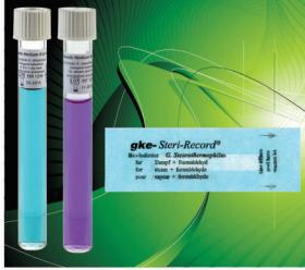
۱- انديکاتورهای بیولوژیک نواری (Indicator-Strips) این نوارها در پوششی از گلیسین که نسبت به بخار، اتیلن اکساید و فرمالدهید نفوذ پذیر است، قرار دارند. در صورت عدم وجود امکانات آزمایشگاهی میکروب شناسی، کمپانی gke محیط های کشت آماده را ارائه میدهد.
