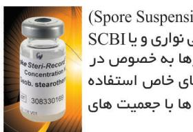
۴- انديکاتورهای بیولوژیک سوسپانسیونی (Spore Suspensions) در مواردی که استفاده از انديکاتورهای بیولوژیک نواری و یا آمپولی محدود نمی باشد، از این انديکاتورها به خصوص در صنایع داروئی و غذایی و لوازم با پیچیدگی های خاص استفاده می گردد. لازم به ذکر است که سوسپانسیون ها با جمعیت های مختلف میکروبی موجود می باشند.
